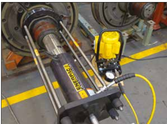
◀ Tažení kolejových kol pomocí hliníkového válce RACH poháněného čerpadlem řady ZE.
