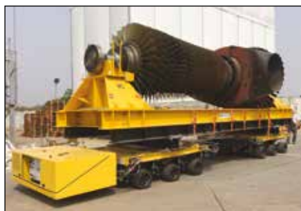
Přeprava rotoru turbíny.
