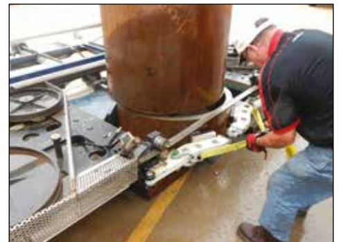
▲ Řezání potrubí s použitím přenosné pásové pily BS.
