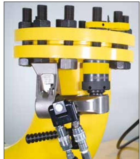
▲ Systém momentového klíče pracující bez nutnosti držení: Model STLLS s momentovým klíčem řady S. Výstupní čtyřhran klíče lze snadno nahradit momentovým zámek Safe T™ Torque Lock
