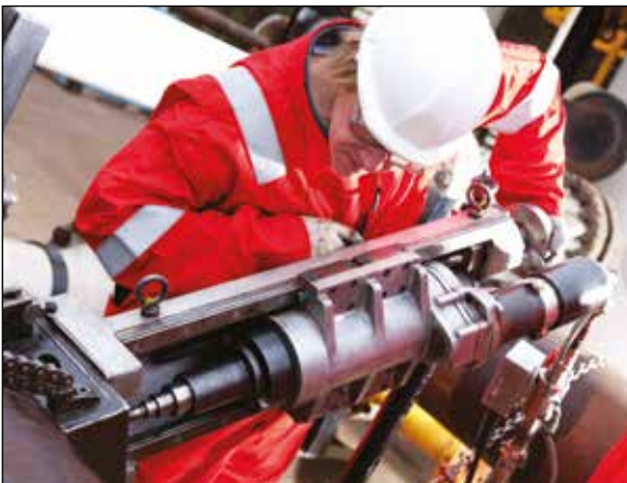
▼ Přenosné zařízení na vrtání HT40.
